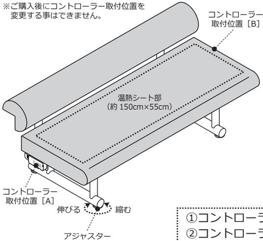
ベッドの設置後、床との隙間により安定しない場合は、アジャスターで微調整して安定させてください。
