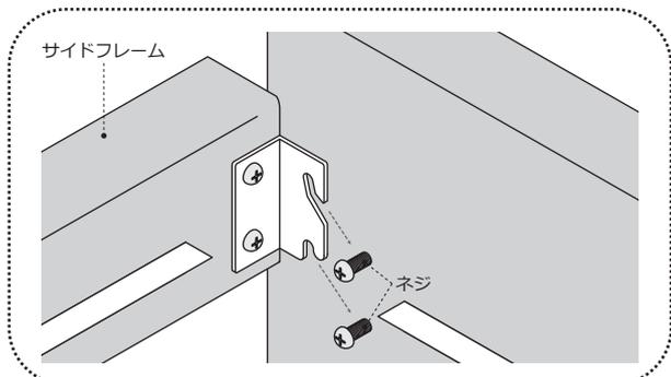
上図のようにヘッドボード・フットボードに仮止めされたネジに、サイドフレームの金具をひっかけてください。
