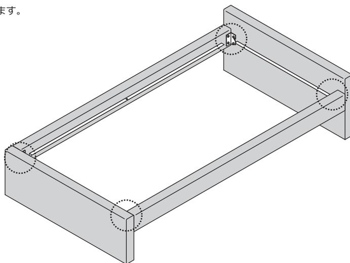
②サイドフレームにセンターステーを仮組みします。その後、ネジ 10ヶ所（ヘッドボード 4ヶ所・フットボード 4ヶ所・センターステー 2ヶ所）を確実に締め付けてください。
