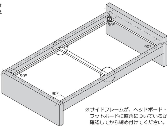
※サイドフレームが、ヘッドボード・フットボードに直角になっているか確認してから締め付けてください。
