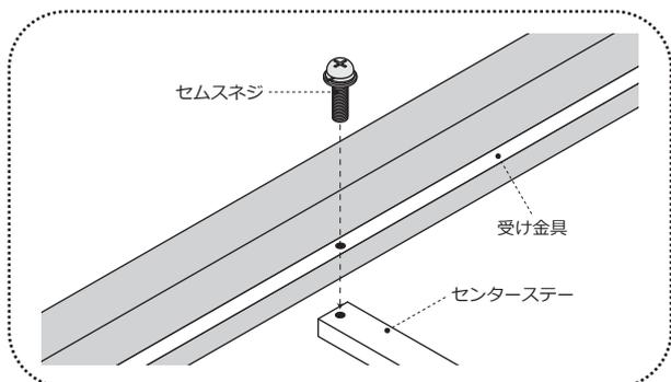
上図のようにセンターステーは受け金具（サイドフレーム）の下側になるようにセムスネジ（センターステー用）で止めてください。
