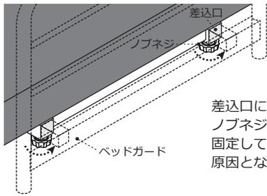
差込口にベッドガードを差し込み、ノブネジ（2カ所）をしめ、しっかり固定してください。ガタつきや脱落の原因となります。
