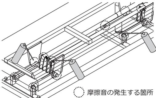
● 市販のグリーススプレーで3ヶ月を目安に可動部分に適量吹き付けてください。給油を怠ると、ガタつきや摩擦音の原因となります。
